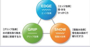
冬の道がすべりやすいのは、タイヤと路面の間に氷の膜や雪が入り込み、摩擦が小さくなってしまいます。さらに日本の冬の道はアイスバーンからシャーベット路面、新雪までさまざまに変化します。冬の道でタイヤがしっかり止まるためには、路面をひっかくエッジ効果、水の膜を取り除き路面に密着するグリップ効果、雪を踏み固めて前進する雪踏み効果の「3つの力」のバランスが大切です。
